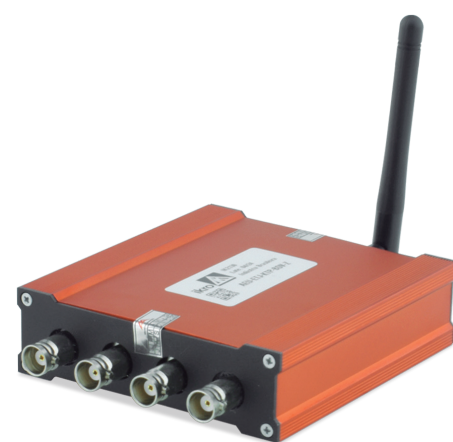
OSCIOSCÓPIO AUTOMOTIVO COM 4 CANAIS INDEPENDENTES 80MHZ DE AMOSTRAGEM BUFFER DE 40K A 10M DE PONTOS S18.IK2130
