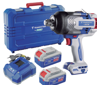
CHAVE DE IMPACTO 20V 3/4" 1.350NM C/SOQUETE 27MM 30MM 32MM (2 BATERIAS 20V 5,0AH + CARREGADOR + MALETA) 42303913
