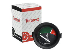
TU300453 ELÉTRICO PRETO 52MM 12V 40°C (325 OHMS) A 120°C (60 OHMS) MF265
