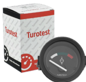
TU300414 ELÉTRICO PRETO 52MM 12V 40°C (287,4 OHMS) A 120°C (22,7 OHMS)
