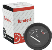
TU300091 ELÉTRICO PRETO 52MM 12V 40°C (147 OHMS) A 120°C (99 OHMS)
