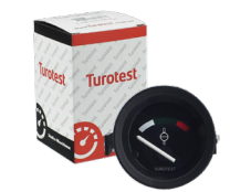
TU300095 ELÉTRICO PRETO 52MM 12V 40°C (75 OHMS) A 120°C (8 OHMS) VALMET 118 148 85>
