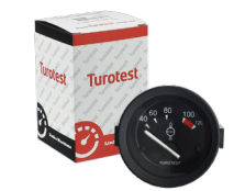
TU301024 ELÉTRICO PRETO 52MM 12V 40°C (325 OHMS) A 120°C (60 OHMS) MF250 MF265 MF299
