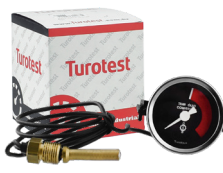
TU302425 MECÂNICO ÓLEO 52MM 40° A 140°C 1,35M MF 86R 250 750 (ROSCA 5/8" 18UNF)
