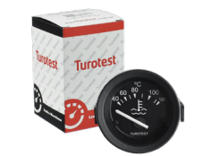
TU300477 ELÉTRICO PRETO 52MM 12V 40°C (380 OHMS) A 120°C (20 OHMS) MF
