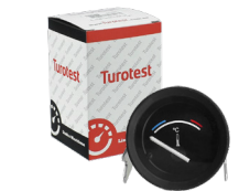
TU300430 ELÉTRICO PRETO 52MM 12V 40°C (300 OHMS) A 120°C (24 OHMS) VALTRA
